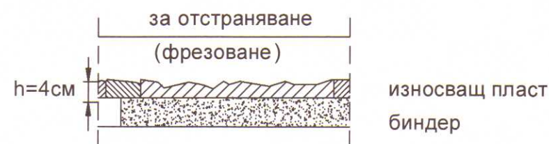
ДЕТАЙЛ No1 - Фрезование на повредени площи
