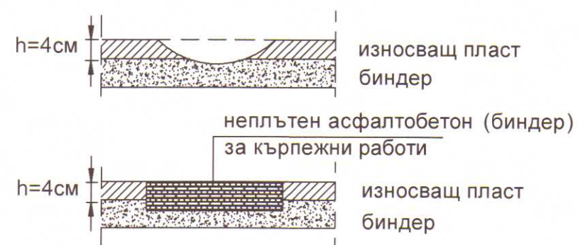
ДЕТАЙЛ No4 -Изкърпване на дупки
